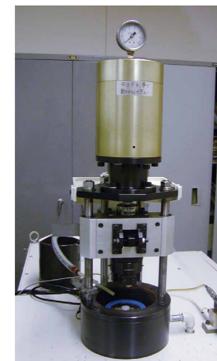
写真 B-11: ピンオンディスク試験機 Photo B-11: Pin-on Disk test machine
