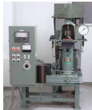
写真 B-14：曾田式四球摩耗試験機 Photo B-14：SOTA-4-Ball wear test machine
