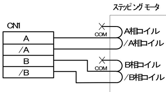
結線方法2: 高トルクで且つ低速で使用されたいときに有効となります。モータの発熱を結線方法1と等価にするためには最大電流を70%に絞ってご使用ください。その際低速域のトルクは1.4倍となりますが、コイルのインダクタンスが結線方法1と比べ4倍となりますので回転数の上昇に対するトルクの落ち込みが大きくなります。
