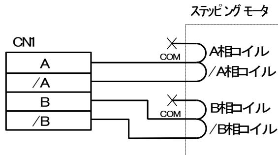
結線方法2：高トルクで且つ低速で使用されたいときに有効となります。モータの発熱を結線方法1と等価にするためには最大電流を70%に絞ってご使用ください。その際低速域のトルクは1.4倍となります。
