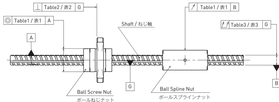
表1 : ねじ軸の軸線に対するナット外周面の半径方向円周振れ
