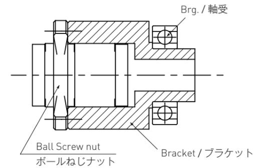
ナット外径に直接軸受を取付け
