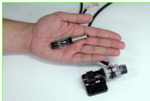
KSS最小ボールねじ (軸径; φ1.8mm、リード; 0.5mm)
