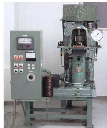
写真 B-14：曾田式四球摩耗試験機
