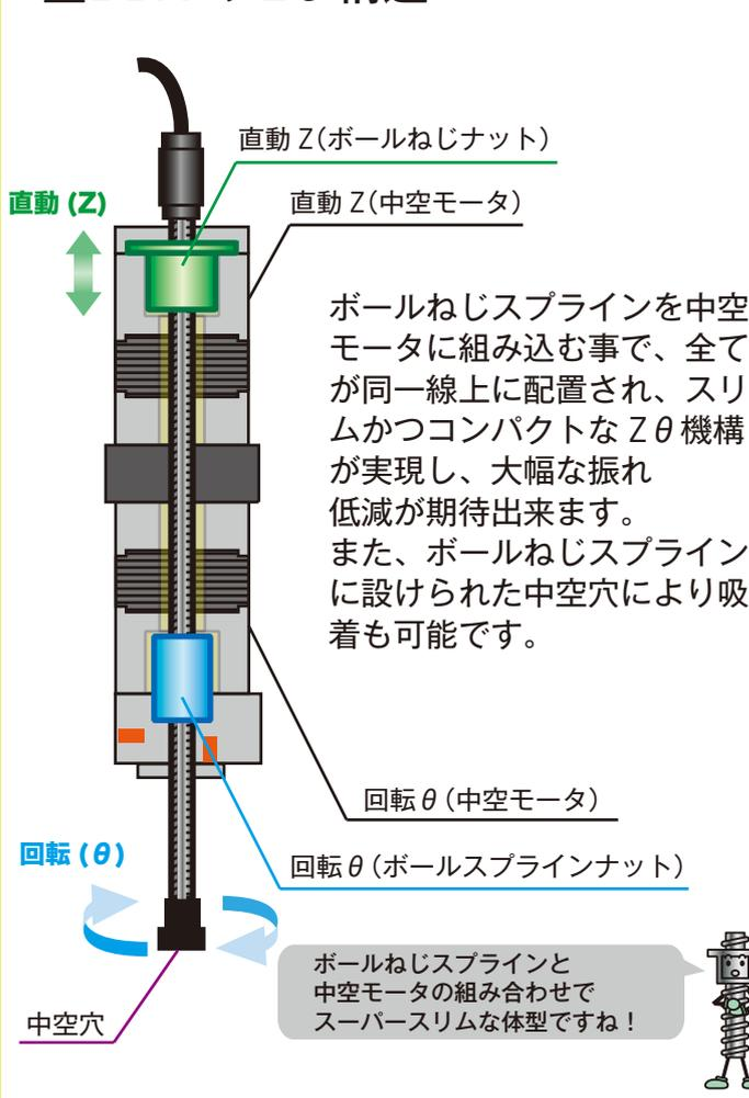
DDA Zθ アクチュエータはモータサイズが□42、□28 の 2 種類をご用意しております。モータサイズによりストロークと可搬質量の選択肢が豊富にあります。
