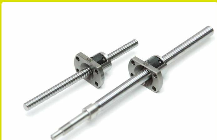
ボールねじの精度は、JIS によって規定されており、精密級と並級(通称)に分類できます(下図参照)。一般的には、精密級は研削加工、並級は転造加工で製作しています。KSS では精密級の一部である Cp5 級を転造加工で実現することに成功し、コストパフォーマンスの高い高精度な転造ボールねじの供給を可能にしました。
