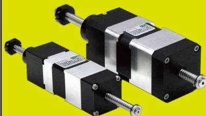
直動に必要なボールねじと案内機構(CLタイプを除く)がシリンダ内に収納されているため、コンパクトはもちろん、部品点数の削減にもつながります。中空モータでボールねじナットを駆動し、ねじ軸を出力するため、極めてコンパクトな直動機構を簡単に構築できます。
