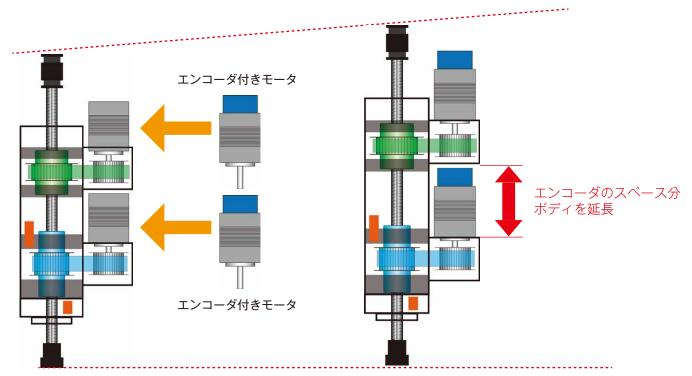
イラストのようにエンコーダ付きに変更する場合、ボディを延長する必要があります。ボディが延長されるとストロークが犠牲となってしまうため、ボールねじスプラインを延長することでストロークを確保しようとしますが、長尺ボールねじスプラインは製作が困難になるため、KSS へお問い合わせください。
